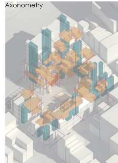
既存の雑居ビルの動線コアを利用して、各住戸へのアクセスが実現されている
